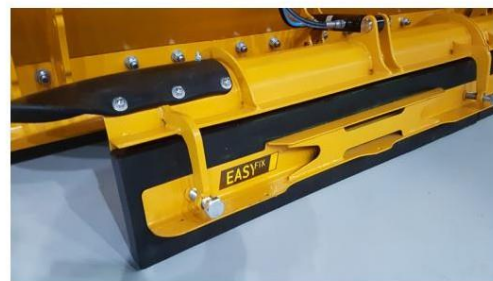
Hydraulisk moddskär med EASY Fix snabbkopplingssystem för gummiblad.
