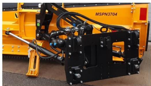
Patenterad sidoförskjutande parallellogram
