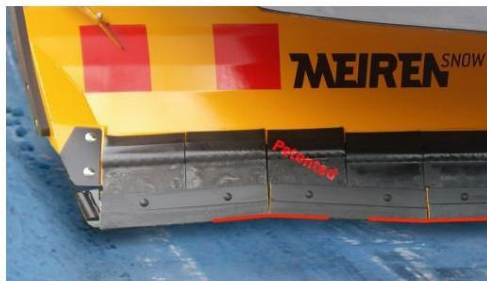
Patenterade skärhållare för rengöring av vägytan Viker sig uppåt/bakåt för hinder.
